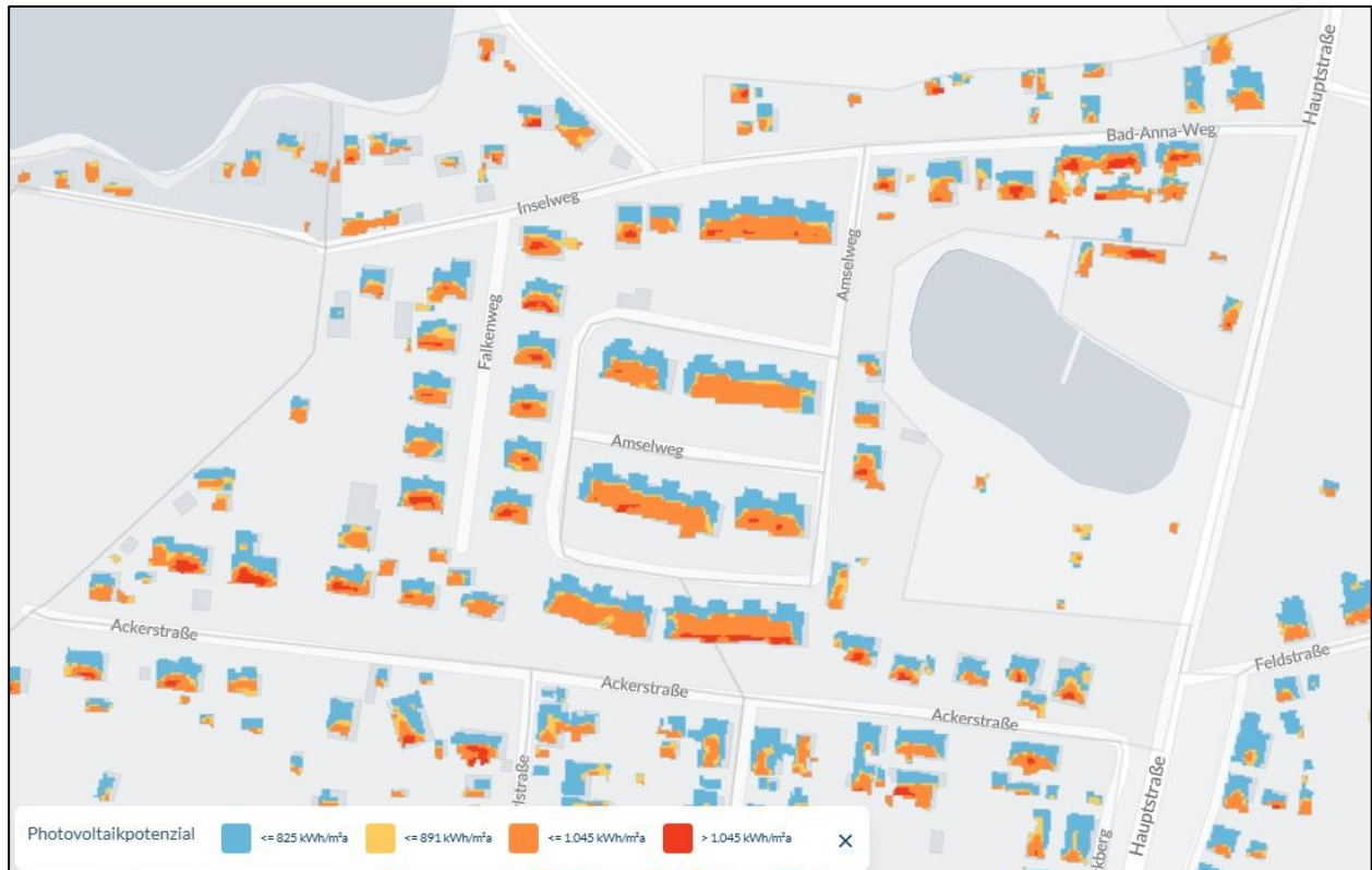
Abbildung 41: Photovoltaik-Potenzial auf Dachflächen in Helbra (beispielhafter Ausschnitt)
